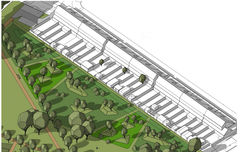
geen schaduw in de tuinen op 1 juli om 18 uur
