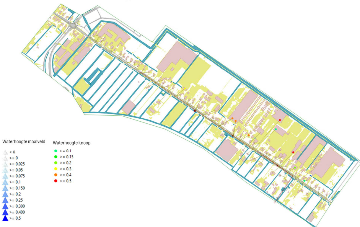
Figuur 4-5 Afvoerend oppervlak halveren - 70 mm
