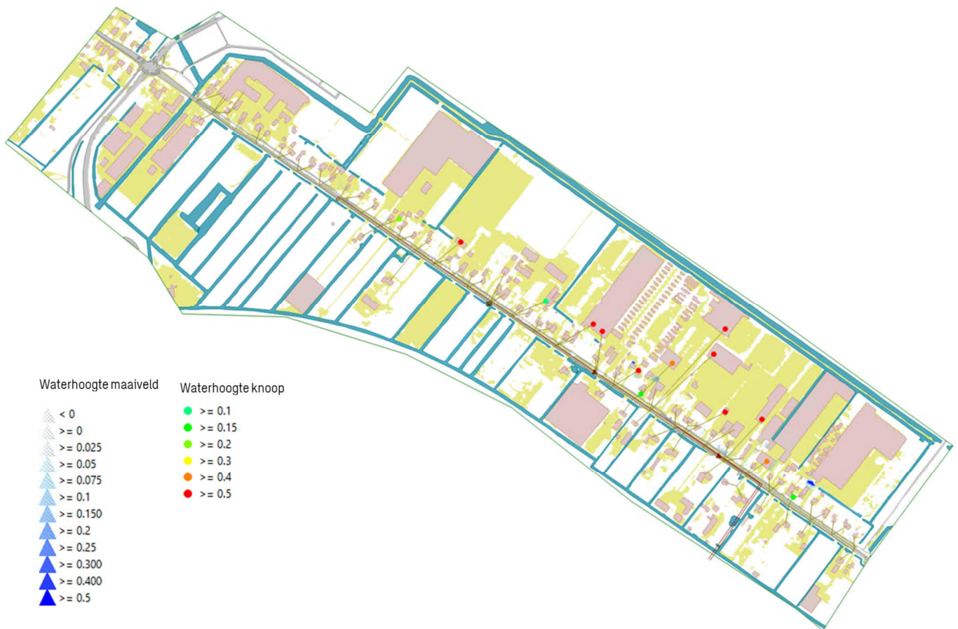
Figuur 3-3 Resultaat bui 70 mm stationair met de huisaansluiting op het maaiveld
