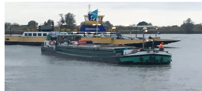
Afbeelding 4: Spits 38 m. lang 5,05 m breed laadvermogen ca. 350 ton equivalent aan 12 vrachtwagens
