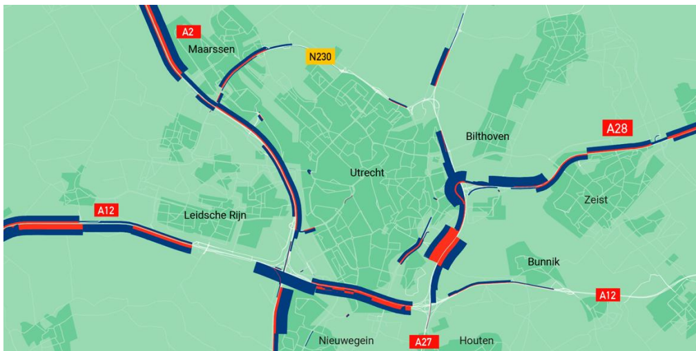
Figuur 1. Impressie van knelpunten in de ochtendspits in 2040 zonder ingrepen (dus ook zonder het uitvoeren van het Tracébesluit). De rode stukken geven aan waar file ontstaat, in blauw hoeveel verkeer in de file staat.
