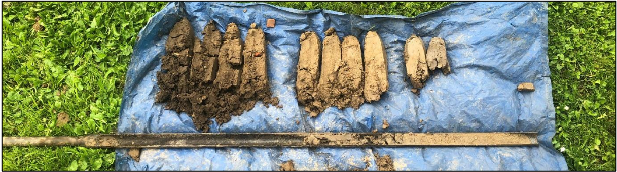
Boring 8: 0-200 cm -Mv. Deel 200-250 cm -Mv loopt uit boor door grondwater.
