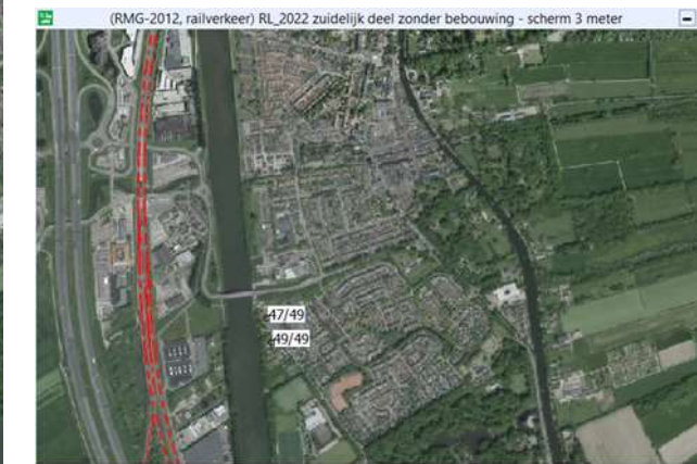
Effect geluidscherm voor Breukelen Boven geluidbelasting op 1,5m/4,5+ en onder na oprichten geluidschermen. Effect circa 10 dB
