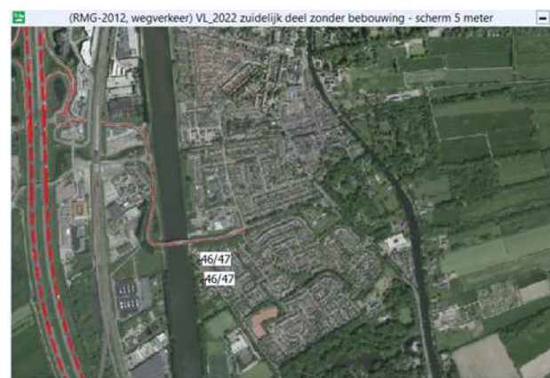
Effect geluidscherm voor Breukelen Boven geluidbelasting op 1,5m/4,5+ en onder na oprichten geluidschermen 5m hoogte. Effect circa 10 dB
