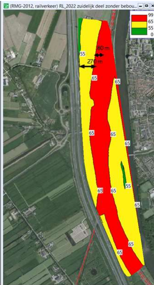
Contour op 20 meter | scherm 3m+ langs sporen
