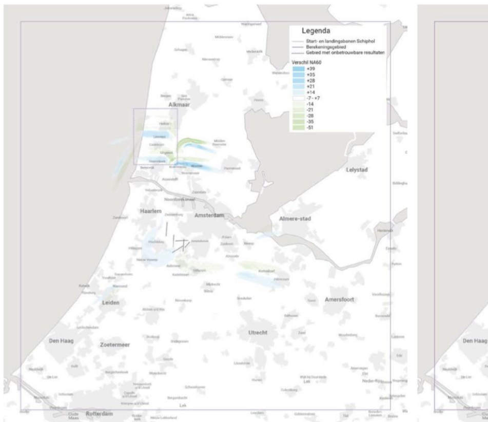
Figuur 6: Verschil tussen de situatie nu en het Schetsontwerp in de maat NA60
