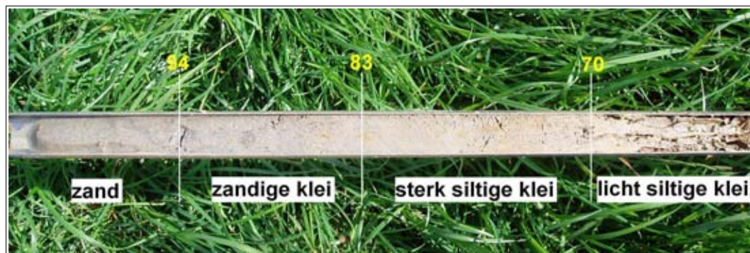
Figuur 8: Vreeland, Kleizuwe 105A: monster boring 41 van 60 tot 100 centimeter diepte. Het monster toont een opwaartse verfijning van sediment. Het zand is afgezet in de bedding, de zandige klei en de sterk siltige klei op een oeverwal en de licht siltige klei in de kom op grotere afstand van stromende rivieren.
