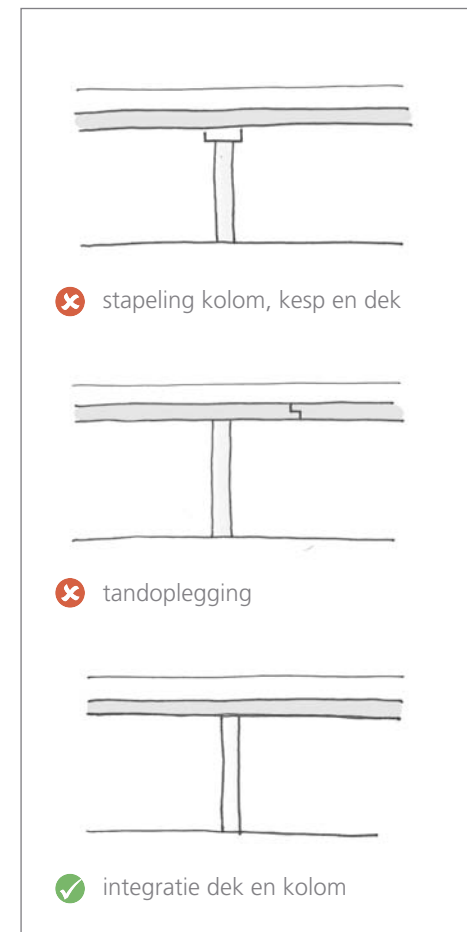
ONTWERPPRINCIPE DEK EN KOLOMMEN AANBRUGGEN
