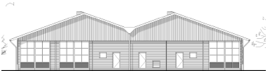
Figuur: Vooraanzicht ontwerp met dubbele nok en verlaagde doorrijhoogte.
