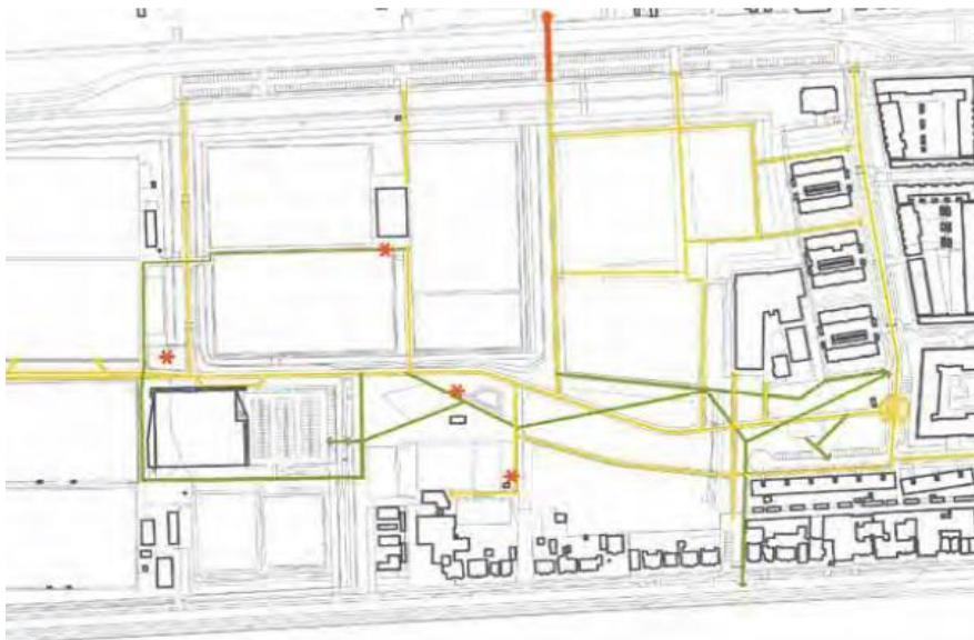
Figuur 5. De verkeersstromen voor langzaam verkeer in het Utrechtse deel van het plangebied. Ter plaatse van doorgaande bomenrij met watergang (bovenaan aan in de tekening), zijn van links naar rechts (noord naar zuid) de volgende paden aanwezig; 1. de bestaande doorsteek naar de Utrechtse sporthal, 2. de nieuw te maken doorsteek bij de nieuwe sportaccommodatie op de te dempen watergang, 3. een nieuw aan te leggen fietspad, 4. de nieuw aan te leggen uitrit voor de nieuw te bouwen woonwijk en 5. de bestaande uitrit va uit Elinkwijk (Jan van Zutphenlaan). De middelste drie worden nieuw aangelegd en veroorzaken dus een nieuwe doorsteek in de bomenrij met essentieel foerageergebied. Bron: IPvE/FO. De kaart ligt gekanteld t.o.v. noord – rechts ligt Elinkwijk, het vierkant links van het midden is de Utrechtse sporthal.
