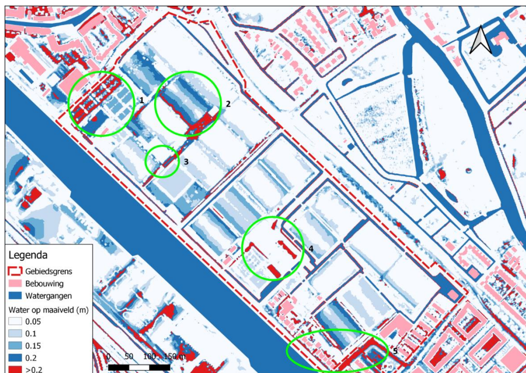
Figuur 7 Maximale waterdieptes op maaiveld in de huidige situatie voor het 80 mm scenario. De groene cirkels geven gebieden van aandacht aan.
