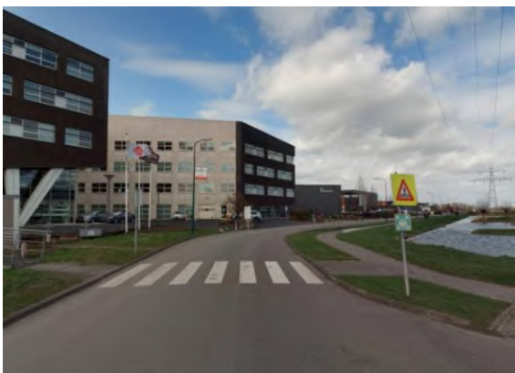
Bij zebra pad Corridor staat niet de formele L02 bebording, alleen het waarschuwingsbord
