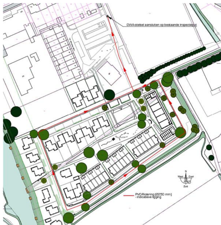
Figuur 10 - Voorstel vuilwaterstructuur
